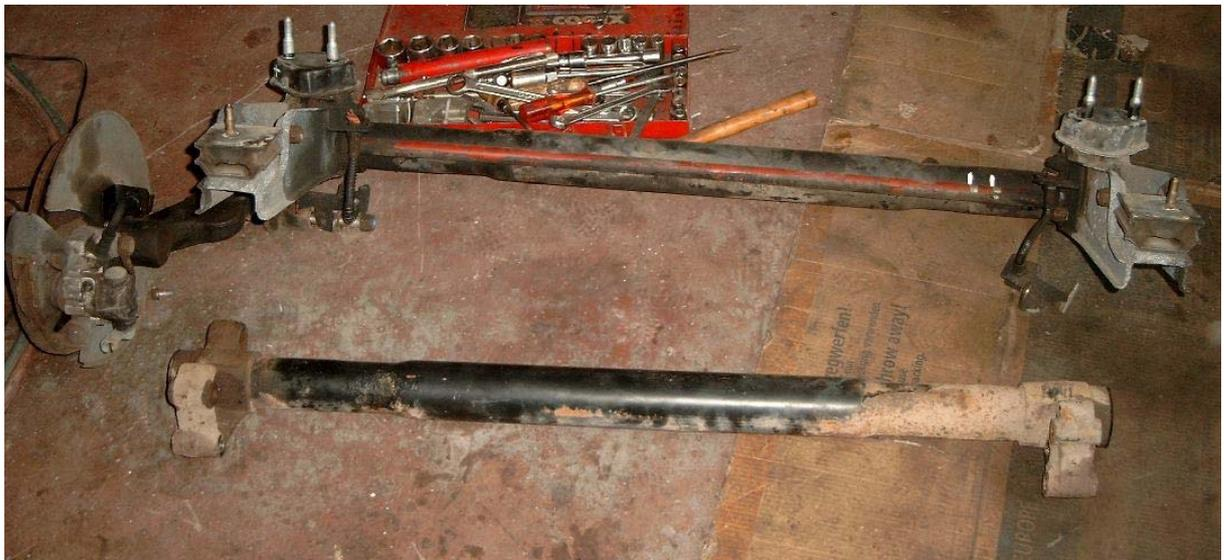
Avant d'extraire les roulements, mesurez la cote d'enfoncement du roulement intérieur : 200mm par rapport au bord supérieur.
