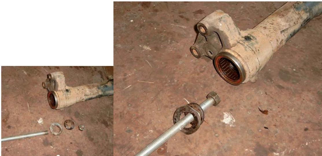
Prenez une tige filetée, une rondelle d'un diamètre très légèrement inférieure au diamètre externe du roulement, et 1 écrou + une rondelle si l'écrou passe au travers de la 1ere rondelle. Faites 2 méplats sur la tranche, de manière à pouvoir insérer la rondelle derrière le roulement en la présentant obliquement.
