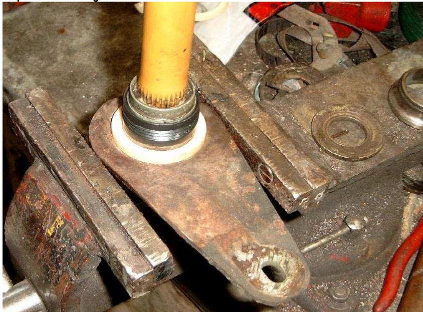
Penser à graisser également les cannelures. Une fois mise en place, insérer le 2ème levier. Faire correspondre les trous de fixation des leviers sur les bras.
