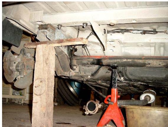
Petit nécessaire pour lever l'Ar de la voiture en 1 point de levage :
