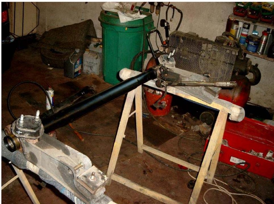
Nettoyer et graisser les cannelures des barres de torsion, mettre la visserie neuve.
