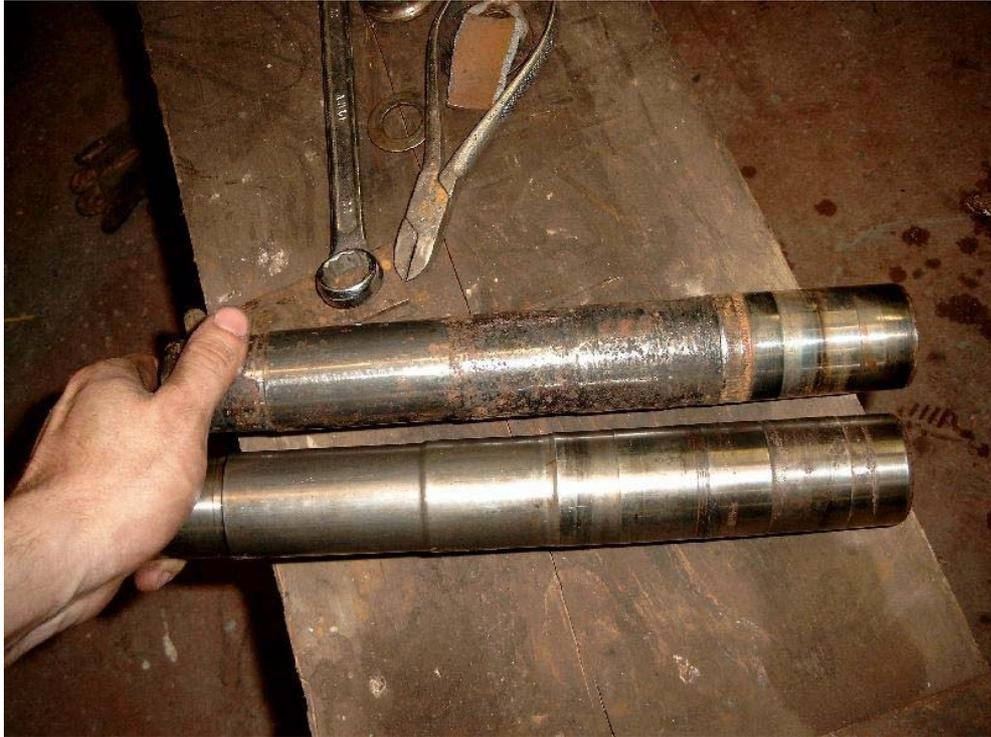
Pour limiter les efforts au remontage de l'axe, j'ai chauffé l'alésage du bras à environ 150°C et refroidi l'axe à environ -40°C :
