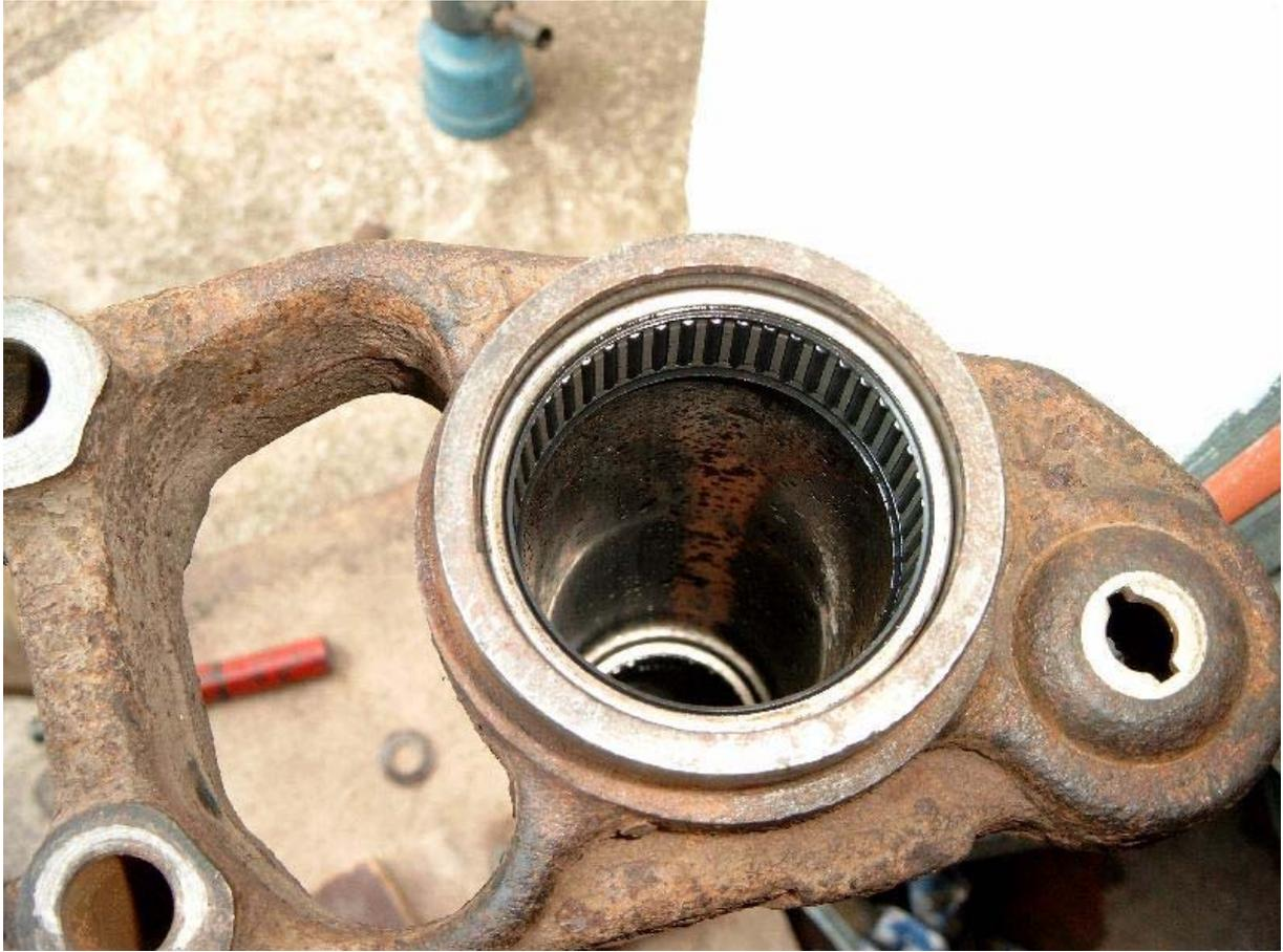
J'ai ensuite étuvé le tube (décapeur thermique soufflant dans le tube) une bonne heure pour éliminer toute trace d'humidité résiduelle.
