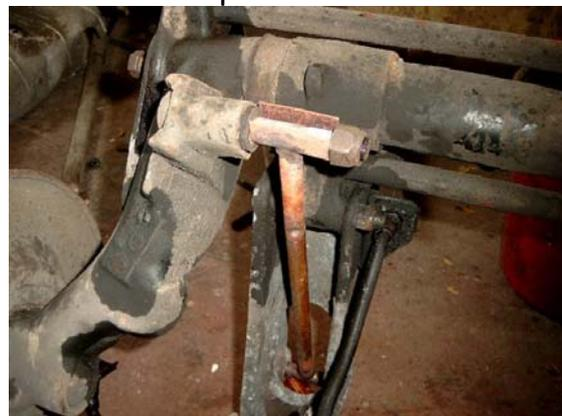
Extraction des leviers de barre de torsion : utiliser une vis de 12x125
